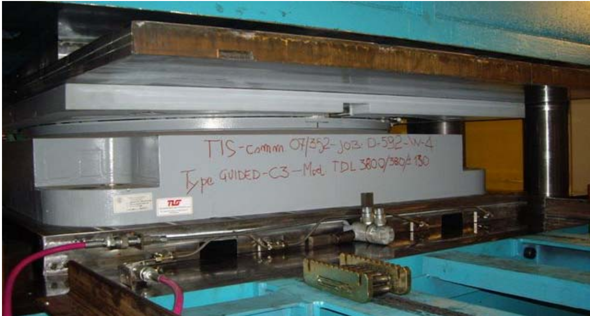
Posizionamento appoggio per la prova del coefficiente d'attrito Bearing setting for Friction test
