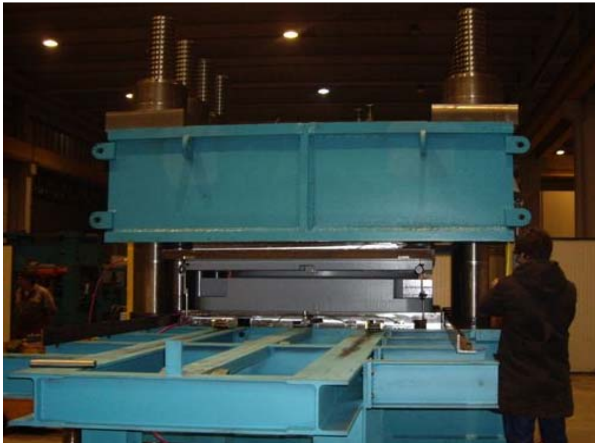
Posizionamento appoggio per la prova del coefficiente d'attrito Bearing setting for Friction test
